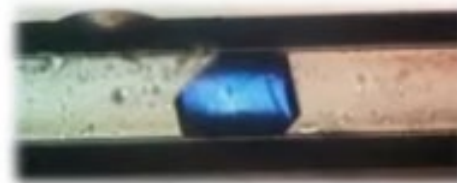
Кристалл белка, выращенный в стеклянном капилляре в космосе.
